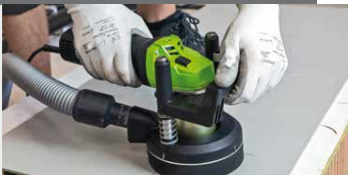
Dokładne pozycjonowanie maszyny za pomocą osłony i oświetlenia LED
